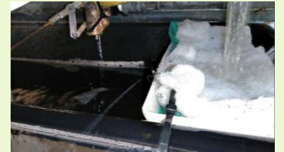
ウールマット・ハードマット・リング濾材の3段構造 養液タンク上に設置
