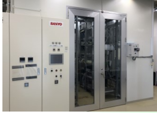
植物工場研究センター C20棟 実験室内 環境シミュレータ装置
